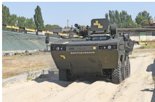
Кліренс 415 мм 415 mm ground clearance
