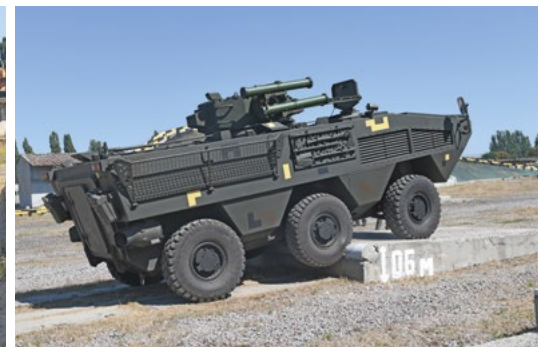
Висота бар'єру 0,6 м Obstacle crossing 0,6 m
