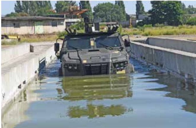
1,2 м глибина ґроду / 1,2 m fording depth
