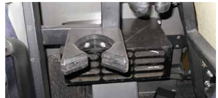
Додатковий випарник системи кондиціонера у відділенні десанту Additional AC evaporator of crew compartment
