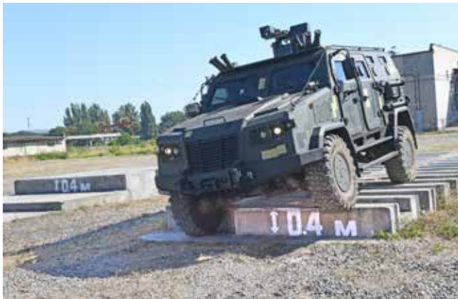
Кліренс 480 мм / 480 mm ground clearance
