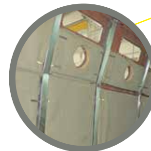
Протиосколковий шар Antispall liner
