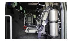
КОЗАК 2 оснащений системами боротьой з вогнем — як для відсіку двигуна, так і для відсіків екіпажу та десанту. Зокрема, системи у відсіках з людьми укомплектовані детекторами полум'я з ультракоротким часом спрацювання та заправлені спеціальною вогнегасною суспензією, що нешкідлива для людини.
