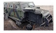
Балістичний захист бронеавтомобілів КОЗАК 2 забезпечується балістичною сталлю та кулестійким склом. Балістична сталь — це спеціально легована сталь, яка має з одного боку надвисоку твердість, з іншого — високу пластичність. Кулестійке скло виробляє «Практика» і являє собою спеціальний склопакет із окремих шарів скла, з'єднаних шарами полімерної плівки, який затримує кулю за рахунок такої багатошарової структури.
