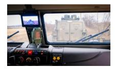
Внутрішній простір КОЗАК 2 організований з огляду на те, що під час виконання бойових місій відділення може тривалий час проводити всередині бронетранспортеру, тому відсіки екіпажу та десанту зроблені просторими, із зручною внутрішньою висотою, шумо— та теплозахистом. Сидіння мають особливу антропометричну форму, завдяки чому солдати залишаються менш втомленими після тривалих поїздок. Усі відсіки мають декількарівневу внутрішню систему освітлення та індивідуальні лампи спрямованого світла.
